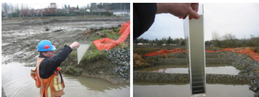
Le prisme Triton pour contrôler la turbidité utilise un récipient et une échelle logarithmique pour mesurer la pénétration de la lumière et pour estimer la turbidité et il ne dépend pas de la profondeur du plan d'eau.
