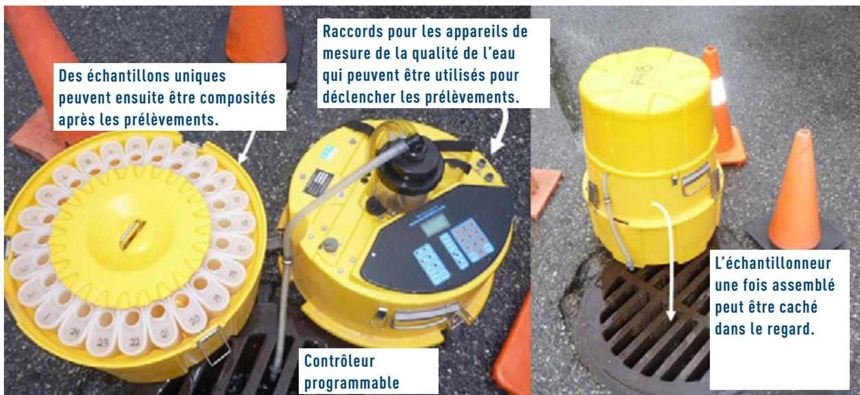
Il existe de nombreux fabricants d'échantillonneurs automatiques. Un grand nombre de ces appareils sont programmables et sont suffisamment polyvalents pour être utilisés dans des situations très diverses. Voici quelques-unes de leurs caractéristiques :
