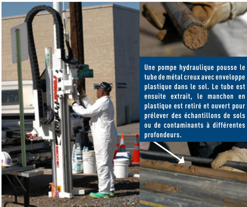
Une pompe hydraulique pousse le tube de métal creux avec enveloppe plastique dans le sol. Le tube est ensuite extrait, le manchon en plastique est retiré et ouvert pour prélever des échantillons de sols ou de contaminants à différentes profondeurs.
