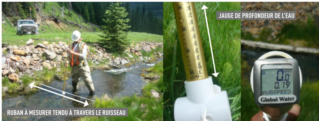
7. Pour calculer le volume d'eau qui passe par un point, multiplier la zone transversale du ruisseau par la vitesse moyenne. L'exactitude de l'estimation augmente avec le nombre de zones transversales.
